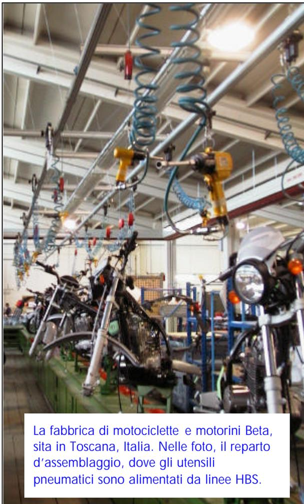
La fabbrica di motociclette e motorini Beta, sita in Toscana, Italia. Nelle foto, il reparto d'assemblaggio, dove gli utensili pneumatici sono alimentati da linee HBS.
